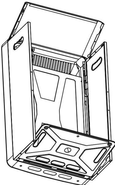
3. Coloque los paneles derecho e izquierdo en el panel inferior, asegúrese de que estén alineados correctamente.
