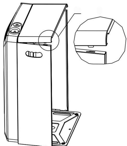
4. Sitúe el panel superior y acomódalo para emparejarlo con el panel izquierdo y con el panel derecho, coloque los ganchos en los orificios correspondientes para asegurar los paneles.
