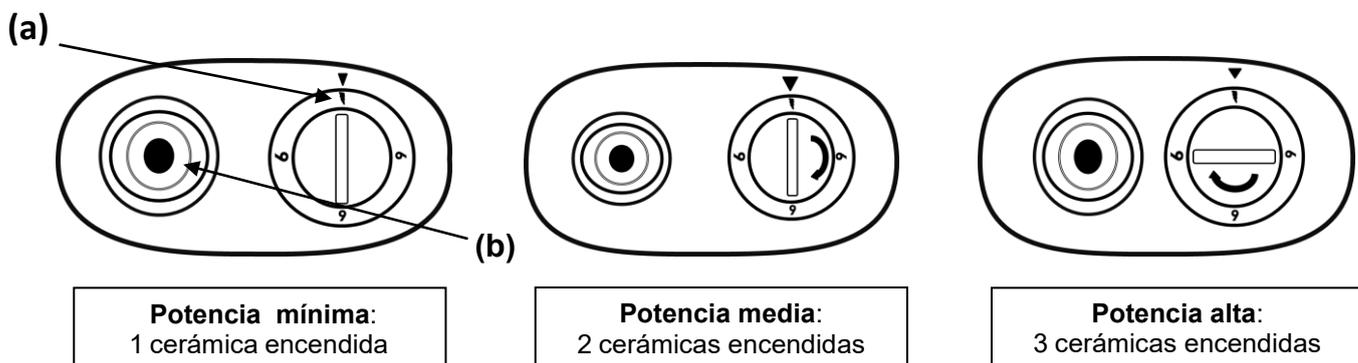
7. Para apagar su calefactor, gire la perilla a la posición de potencia mínima y **cierre el tanque de Gas LP.** (Figura 1)
